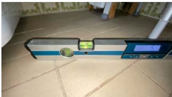
Ca. 5 mm/meter fall mot sluk.
