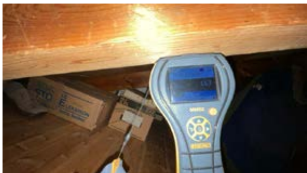
Ved piggmåling i takstolen ble det målt 11,7 vekt%.
