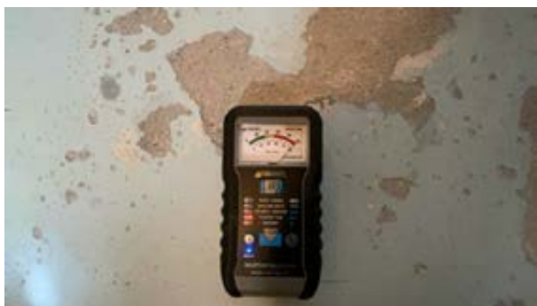
Høyt utslag ved bruk a fuktindikator mot gulv
