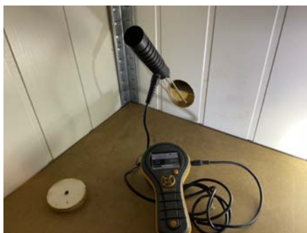
Hulltaking og fuktmåling.
