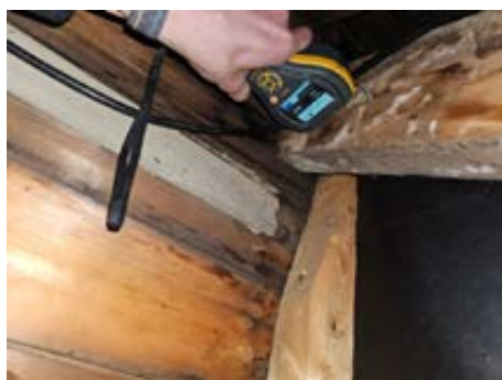
Målt 14 vektprosent i fuktskjold på kott.
