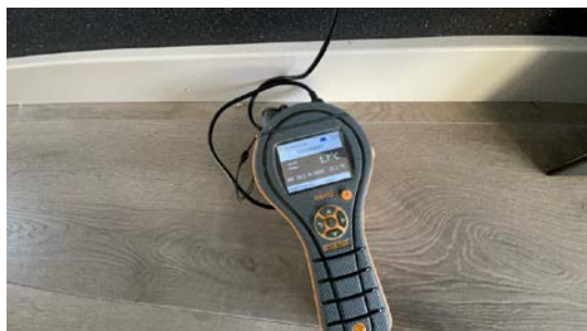
Fuktmåling i vegg mot våtsone
