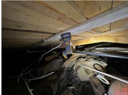
Det er målt 19,3 vektprosent i stubbegulvet.
