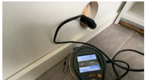
Det ble målt under 7 vekt% ved bruk av piggmåling.
