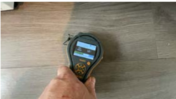
Ingen unormale fuktverdier ved bruk av fuktindikator på gulv ved oppvaskmaskin/vask.
