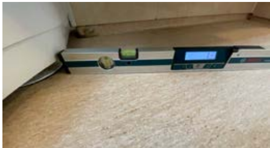
Motfall ved sluk på 1 mm/meter.
