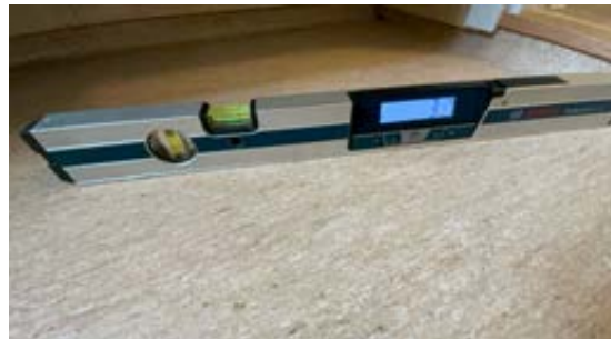
Motfall ved dør på 3 mm/meter.
