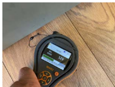
Ingen unormale verdier ved bruk av fuktindikator på kjøkkengulv.
