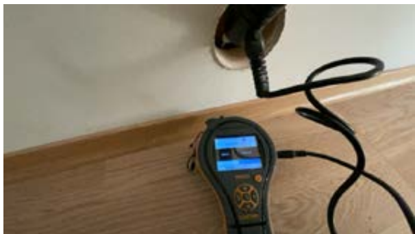
Piggmåling viste under 7 vekt%.
